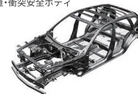
前面衝突安全性能(フロントボディ構造)
