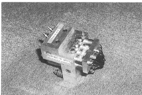
図10 試作油圧ユニットの外形
