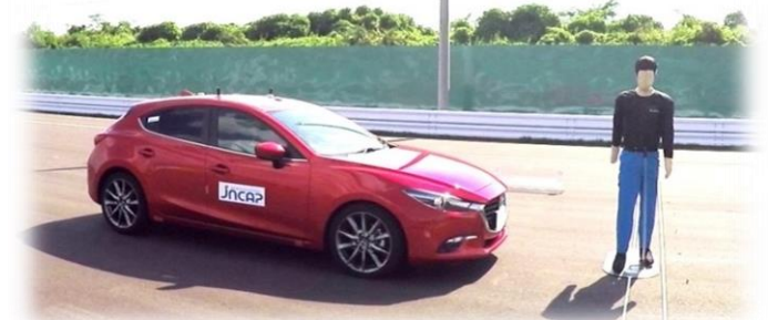
歩行者対応自動ブレーキ試験の様子（写真提供：NASVA）
