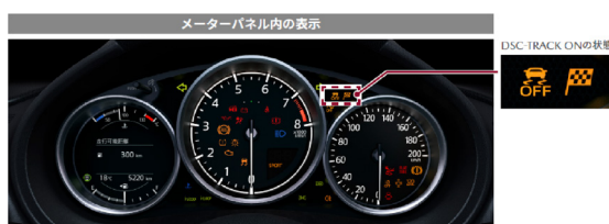
Fig. 12 HMI: Meter Display of DSC-Track
